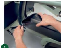
1 Las PowerPack están fijadas al cuadro. Para retirar la PowerPack, abre el dispositivo de desbloqueo con la llave suministrada. Sujeta la PowerPack en todo momento.
