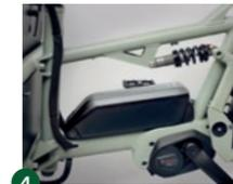
4 Vuelve a colocar la batería siguiendo los pasos en orden inverso. Asegúrate de que la batería esté correctamente insertada y tenga un agarre firme.
